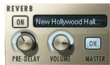
Die Ausführung eines hochqualitativen Halls kann sehr CPU-belastend sein und das ist der Grund, dass derselbe Hall für alle Instrumente einer Audiospur genutzt wird. Das Einschalten des Master-Knopfes, erlaubt es Ihnen eine einzelne Instanz des Hallprozessors zu nutzen und der Effekt wird dann auf mehrere Instrumente angewendet.
